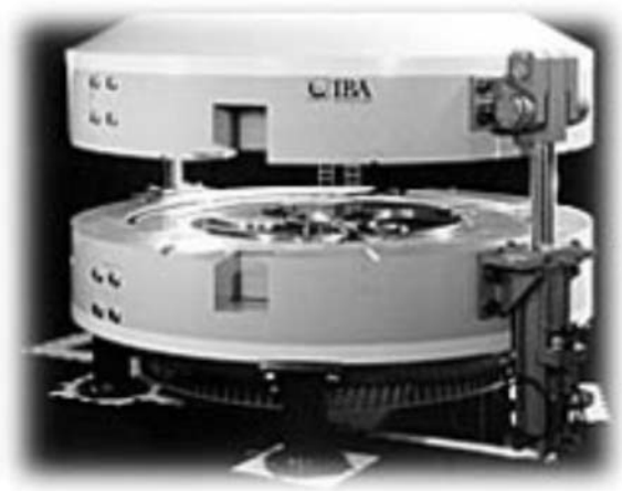
Рис. 2. Общий вид циклотрона фирмы ИВА (энергия протонов 235 МэВ)
